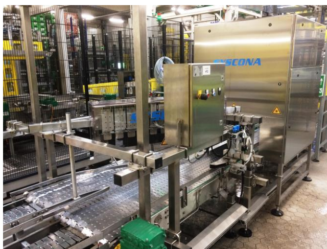
Bild 1: SYSCONA-Kastensortierung bei der Braucommune in Freistadt
