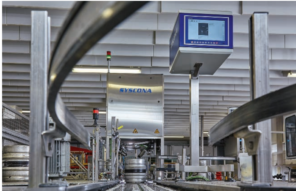
Vollgut-KEG-Inspektion auf Schaumbildung im Bereich des Fittings (Dichtigkeitsprüfung).
