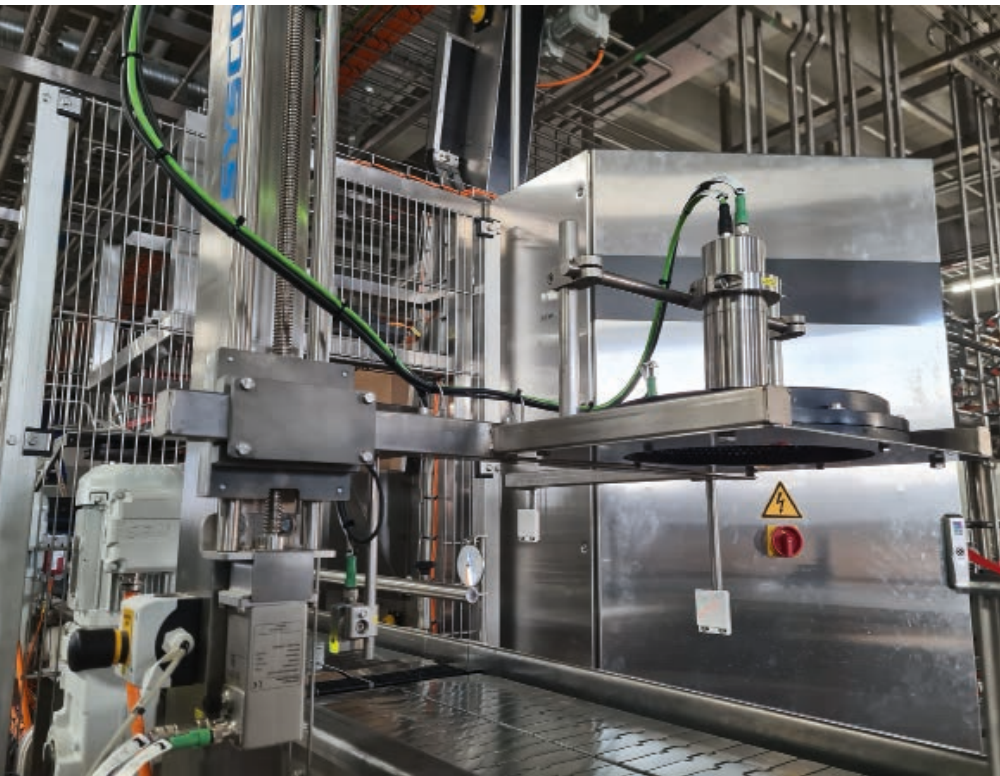
Vollgut-KEG-Inspektion der Siegelkappe zur Prüfung von z. B. Farbe, Etikett, MHD, EAN.
